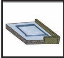
**1** La superficie debe estar limpia y seca. Las pendientes y bajantes deben ser las adecuadas para evitar empozamientos de agua. Instale un plástico de 50 x 50 cm sellado en los bordes con cinta. Si el plástico aparece húmedo después de 24 horas no se debe aplicar Acril Techo®
