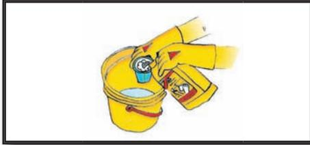
**1** Mezcle el **SikaLimpiador<sup>®</sup>** adecuado con agua en una relación de 1:1 a 1:3. (Realice ensayos para determinar la dilución adecuada).
