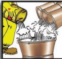
**4** Como mejorador de resistencia del mortero: Mezcle 1 volumen de SikaLatex®-N con 3 de agua y utilice la dilución como agua de amasado.
