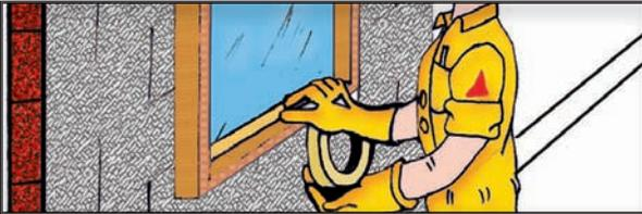
5 Rellene completamente la junta manteniendo la punta de la boquilla en el fondo durante la operación de sellado.
