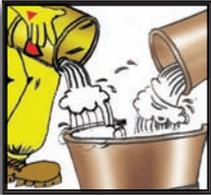
**2** Como puente de adherencia: mezcle en volumen 1 parte de SikaLatex®-N + 1 de agua + 2 de arena + 2 de cemento hasta lograr una consistencia de pintura espesa.
