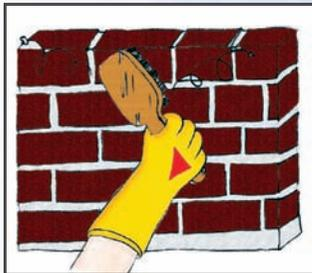
**2** Se recomienda hacer ensayos de campo para determinar la cantidad de capas requerida, lo cual depende del tipo de superficie y de absorción. Se debe de aplicar 2 capas como mínimo
