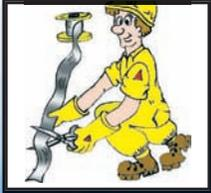
**1** La superficie debe estar sana, seca y limpia. En soportes muy porosos o en impermeabilizaciones asfálticas, mejore la adherencia con Igol Techo. corte la cinta a la longitud deseada
