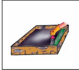
4 Coloque el concreto fresco mientras Sikadur<sup>®</sup>-32 Primer-N se encuentre pegajoso al tacto. (Tiempo máximo 30 minutos después de aplicado el Sikadur sobre el concreto existente).
