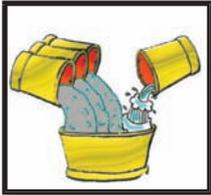
2 Mezcle 3 partes de **Sika®-101 Mortero** con una parte de agua (en volumen) deje reposar 5 minutos.
