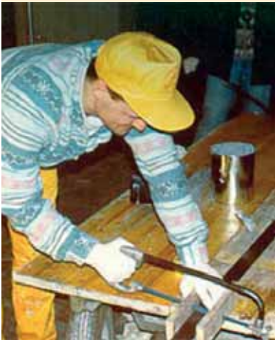
Cortado del laminado con sierra, tijeras o pequeña cizalla
