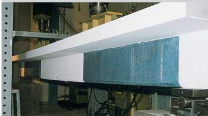
Refuerzo a Cortante en la Viga Armada con SikaWrap-231® y SikaDur®-330
